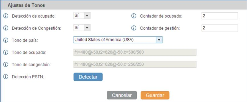
**Figura 28: Configuración de tonos del puerto FXO del UCM6100**
