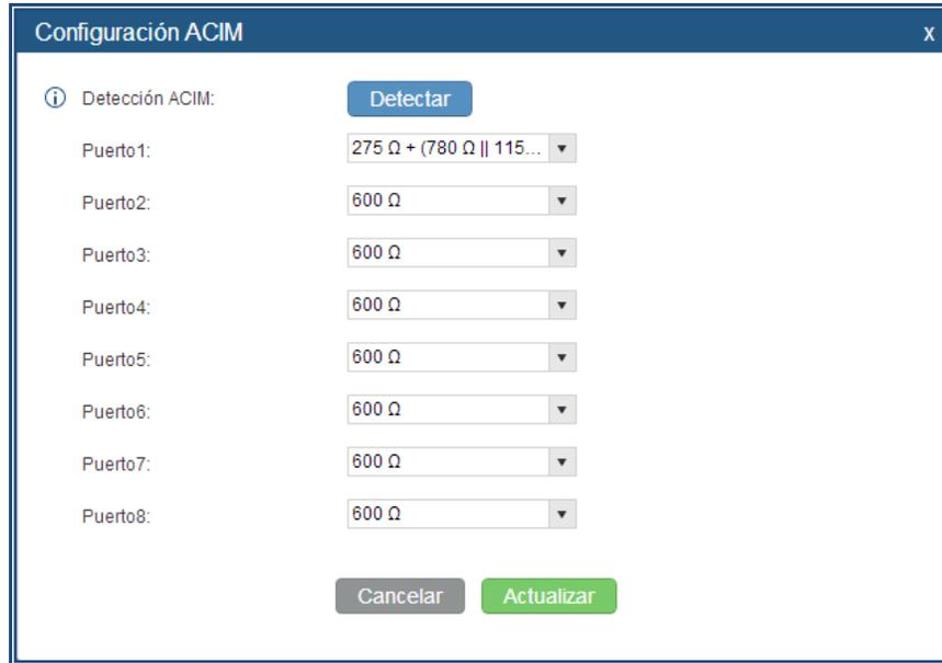
**Figura 68: Configuraciones ACIM para los puertos FXO**
